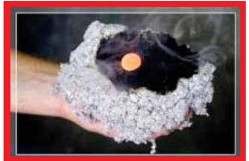
Inoltre vanno ricordate le ottime caratteristiche insonorizzanti di questo isolante, utilizzabile in pareti, tetti e sottotetti.
